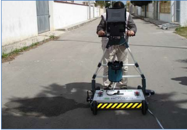
كشف التمديدات بجهاز الجورادر
